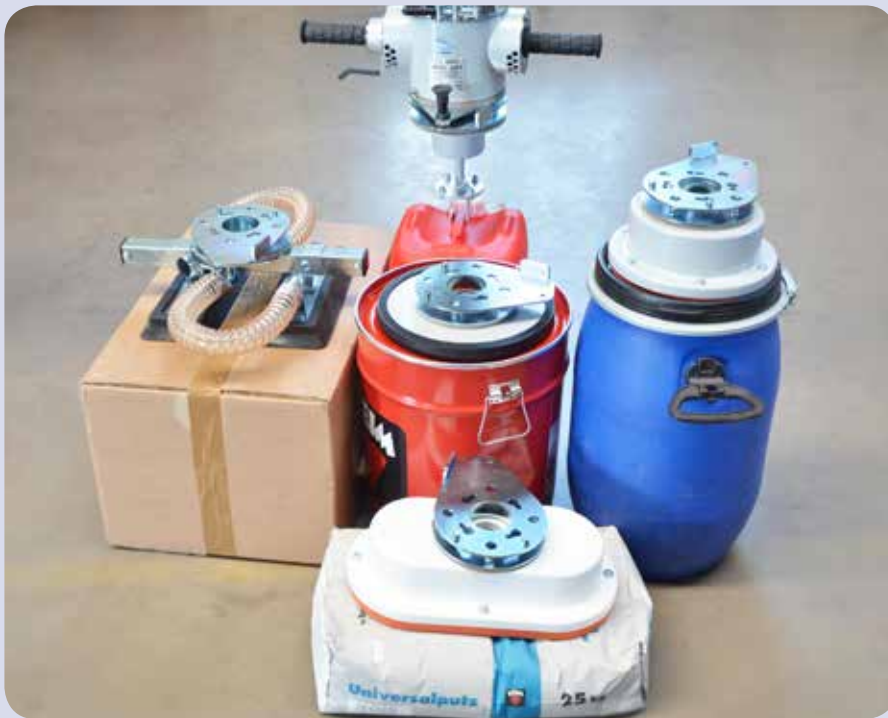
Lastaufnahmen / Sauger mit Schnellwechsellkupplung
