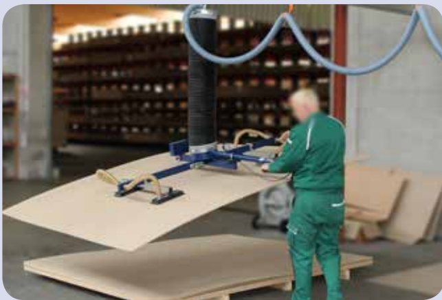
Heben von porösen Holzplatten mit verlängertem Bediengriff
