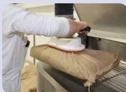
Sackheber in V2A-Ausführung
