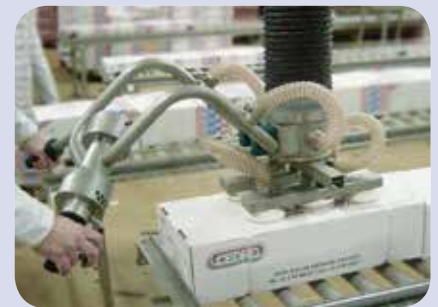
Abwinkelbarer Bediengriff in V2A
