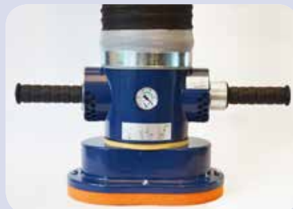
Bedienkopf mit Drehgriff und Vakuummeter
