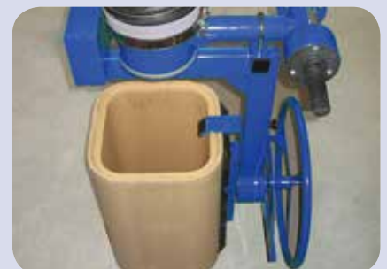
Handling von Kaminsteinen
