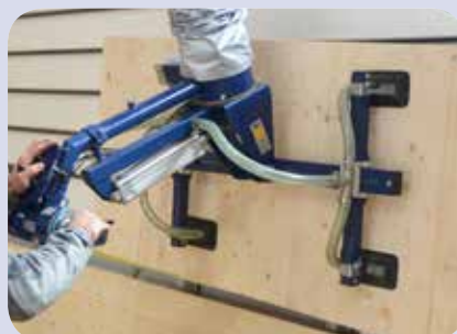
Plattenheber mit pneumatischer Schwenkeinrichtung
