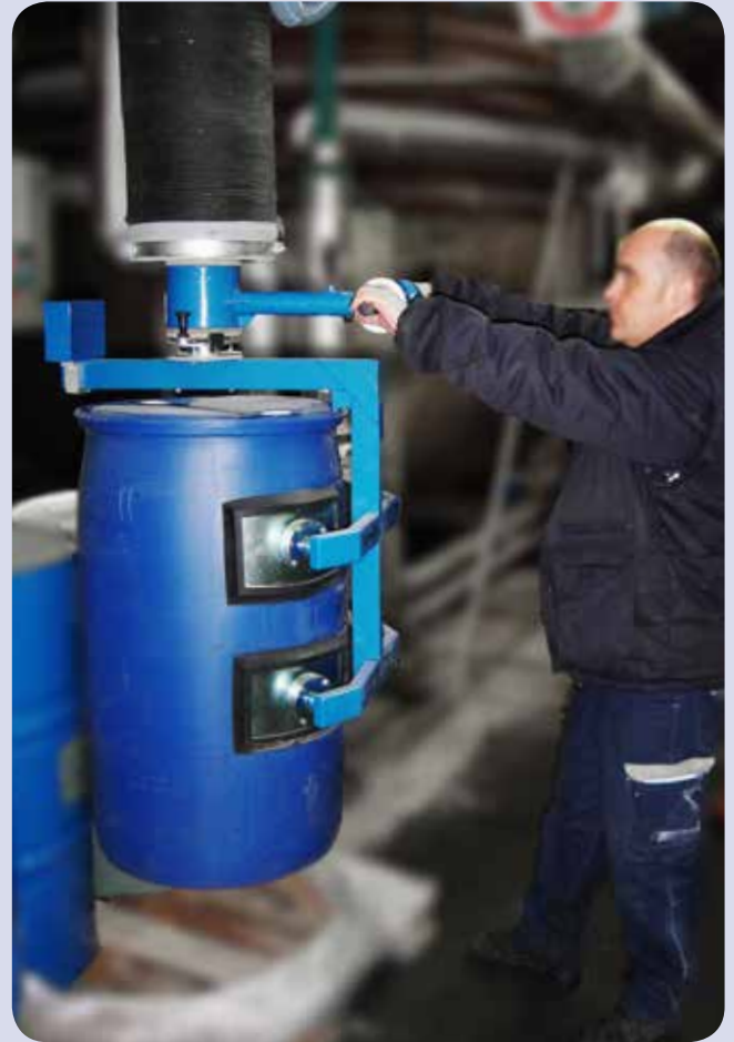
Vertikale Aufnahmeeinheit zum Heben von Fässern
