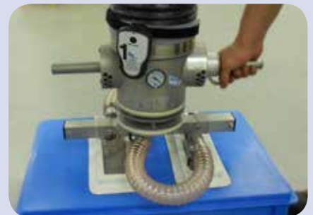
Bedienknopf in V2A mit Funksender
