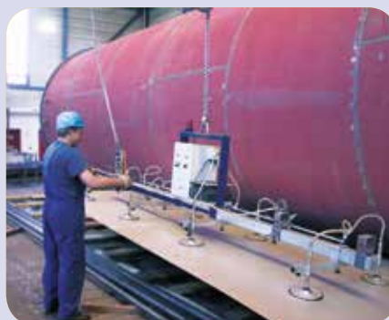
netzunabhängiges Gerät für Bleche bis 1000 kg (AERO 1000/8R-24V)
