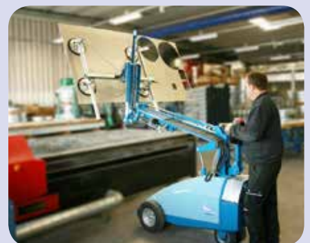
CLAD-LIFT zum kabellosen Transportieren von Blechen
