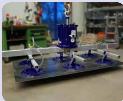
BASIC-LIFT mit 600 kg Tragkraft (BL 600/6L)
