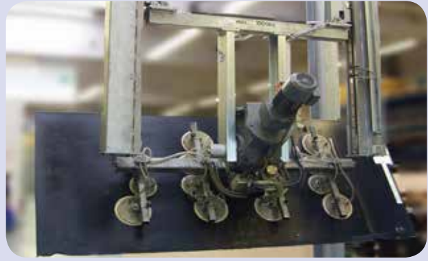
Schwenkgerät mit starrer Lastführung
