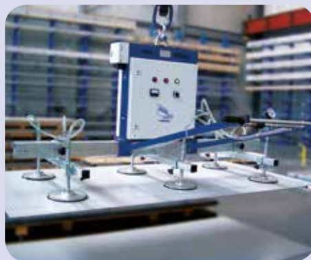
Vakuumhebergerät zum Handling von Blech
