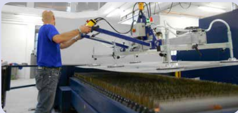
Vakuumhebergerät AERO 900/6R zum Bestücken von Laserschneidanlagen
