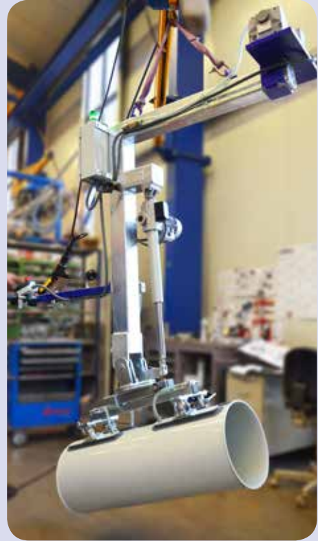
schwenkbares Lasthaftgerät für Blechrohre
