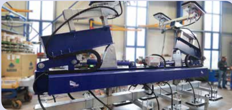
stapeladaptierbares Schwerlastgerät (hydraulisch verlängerbar)
